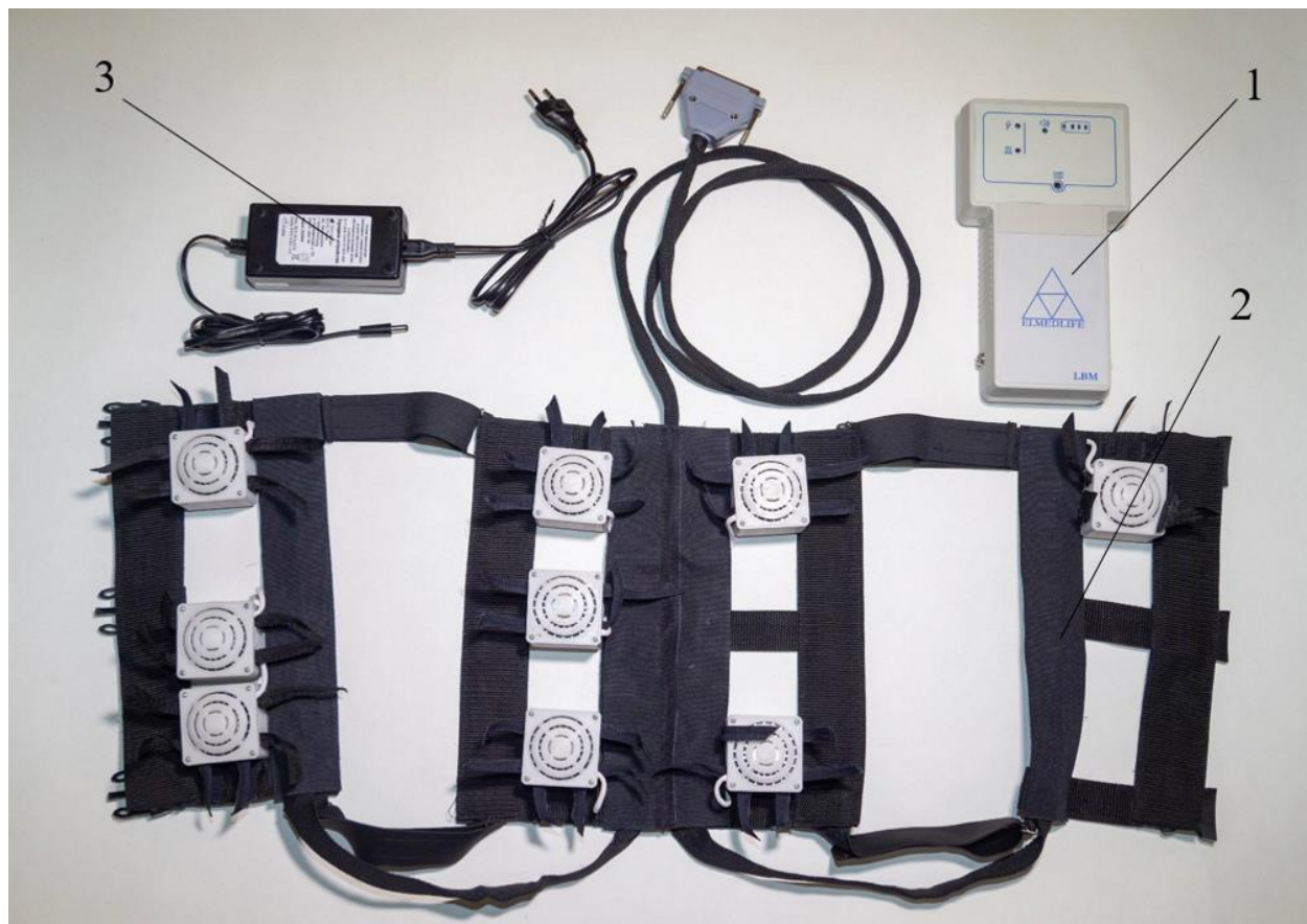
Рисунок 3 – Аппарат матричный для неинвазивного терапевтического воздействия оптическим излучением на внутренние органы и ткани Elmedlife L, где: 1 - Блок управления LBM; 2 - Жилет-гарнитура Elmedlife L; 3 - Зарядное устройство
