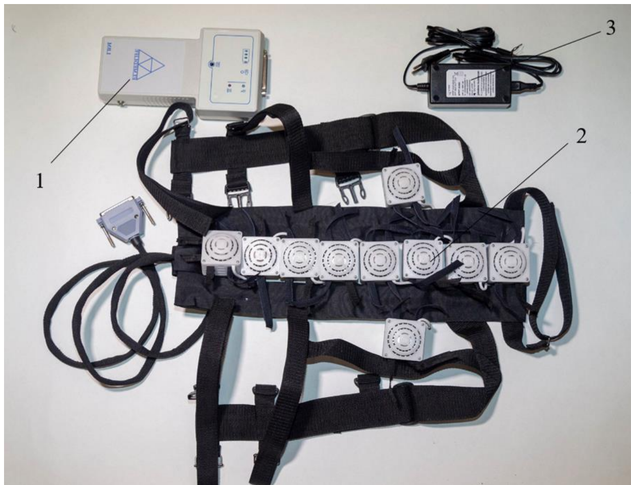
Рисунок 4 – Аппарат матричный для неинвазивного терапевтического воздействия оптическим излучением на внутренние органы и ткани Elmedlife B, где: 1 - Блок управления LBM; 2 - Жилет-гарнитура Elmedlife B; 3 - Зарядное устройство
